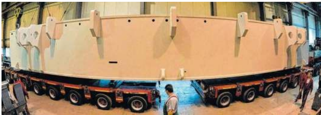
Das Chassis für eine Biegepresse entstand bei der Anlagentechnik Aschersleben und wird per Schwerlasttransport zu Schless auf der anderen Straßenseite transportiert.
